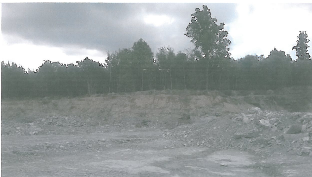
Attēls Nr. 3. Morēnas nogulumu slānis, kas izvietots virs ģipšakmens slāņa, atradnē "Salaspils". Morēnas nogulumu slāņa biezums aptuveni 3 metri.
