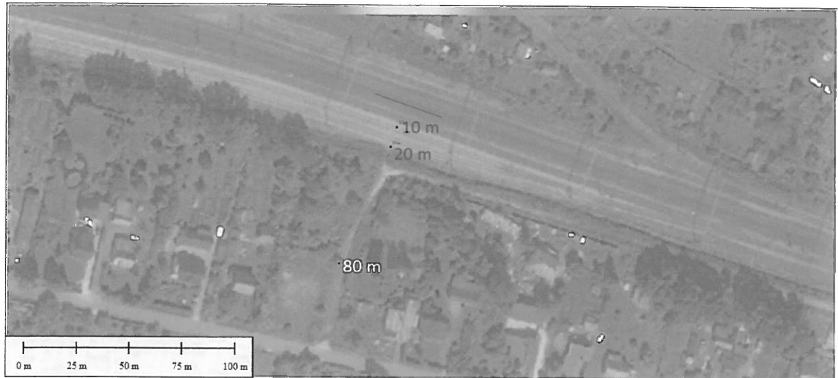
Attēls Nr. 9. Mērījumu veikšanas vieta Salaspilī (T1). Līnija norāda dzelzceļa centrālo līniju. Mazie aplīši ar skaitļiem - seismometru uzstādīšanas vietas ar attālumu līdz dzelzceļam.
