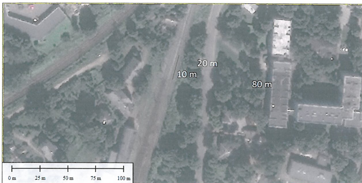
Attēls Nr. 11. Mērījumu veikšanas vieta Torņakalnā (T3). Līnija norāda dzelzceļa centrālo līniju. Mazie aplīši ar skaitļiem - seismometru uzstādīšanas vietas ar attālumu līdz dzelzceļam.
