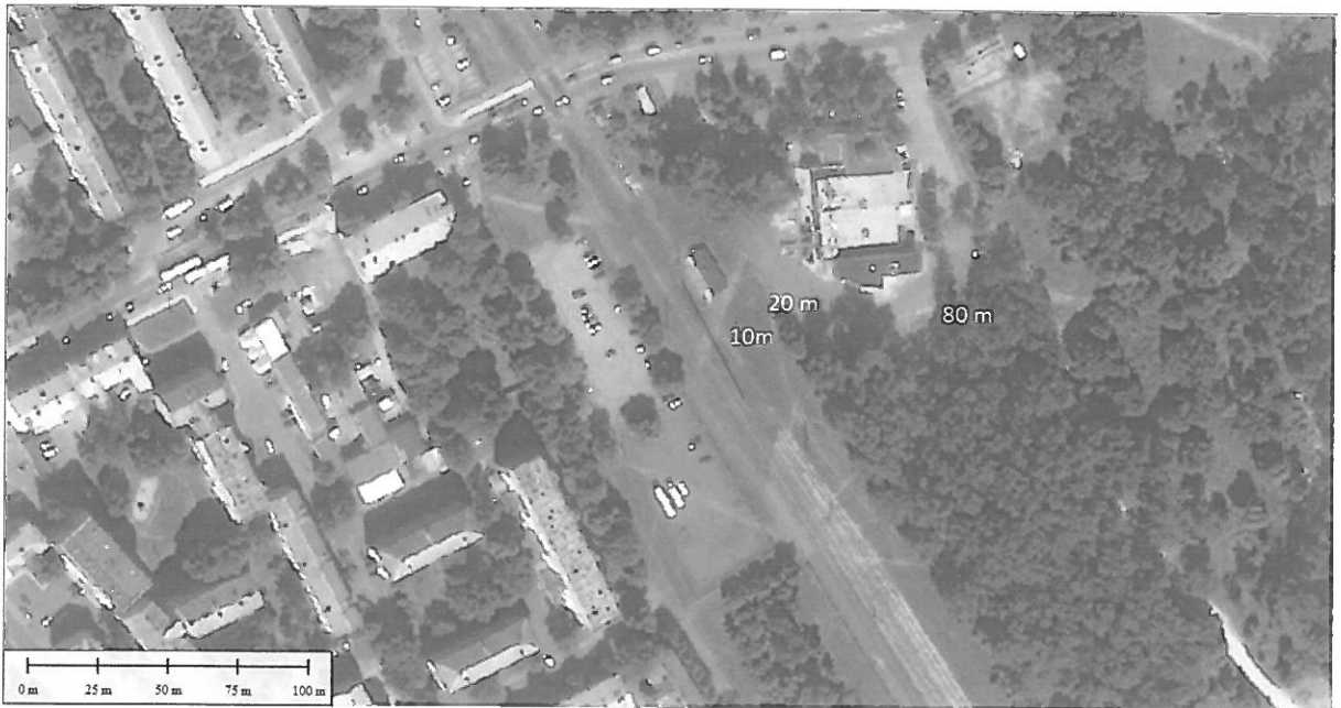
Attēls Nr. 10. Mērījumu veikšanas vieta Sarkandaugava (T2). Līnija norāda dzelzceļa centrālo līniju. Mazie aplīši ar skaitļiem - seismometru uzstādīšanas vietas ar attālumu līdz dzelzceļam.
